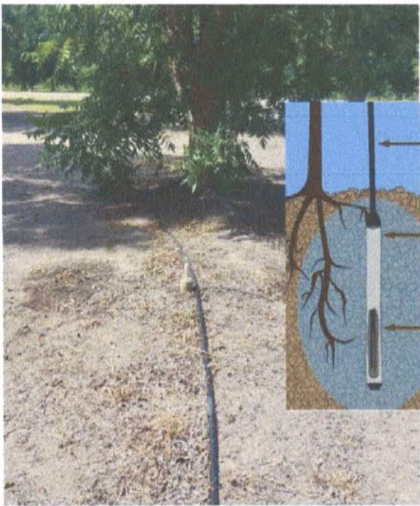
Manguera 1/4" Emisor y Cápsula porosa Dispositivo de cobre
